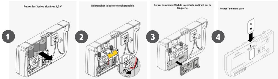
**3** REPLACER LES ÉLÉMENTS dans l'ordre inverse du schéma ci-dessus > **4 3 2 1**
